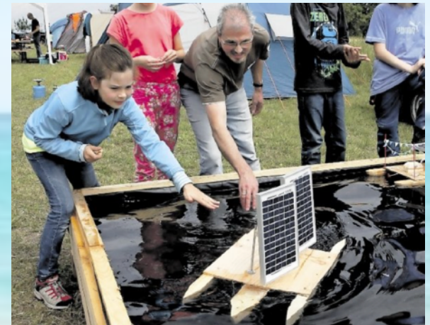
Solarboot mit senkrechten drehbaren Platten
